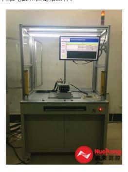
汽车压力传感器耐久性测试台作为一种压力传感器检测机,包括具有工作平台的机架,设于工作平台上并用于放置待测压力传感器的治具,可升降并在下降到位时作用于待测压力传感器的砝码模组,控制砝码模组升降的驱动机构,以及用于显示待测压力传感器性能数值的测试电控仪表,其特征在于,还包括与砝码模组连接的缓冲机构,该缓冲机构用于在砝码模组下降至距待测压力传感器预定距离的位置时减小砝码模组的下降速度,
